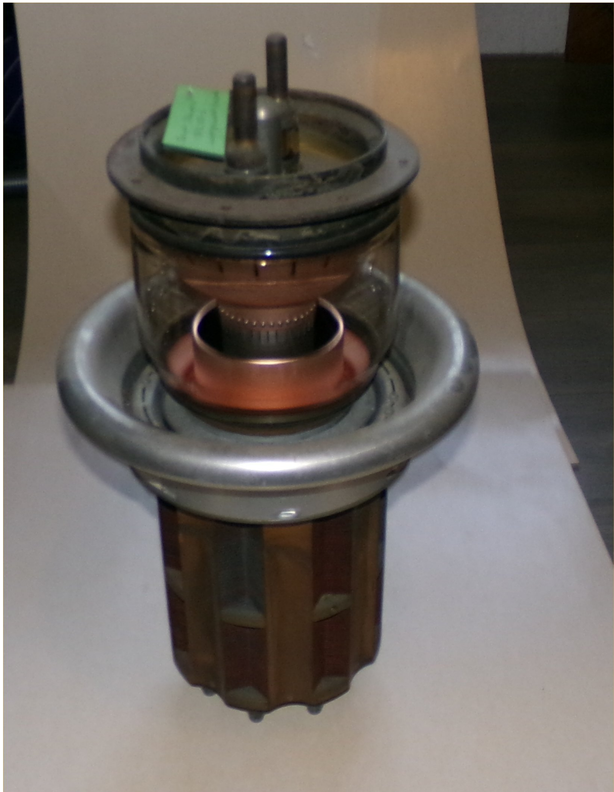
Mijn luchtgekoelde zendlamp van Brown Boveri type BTL25-3
